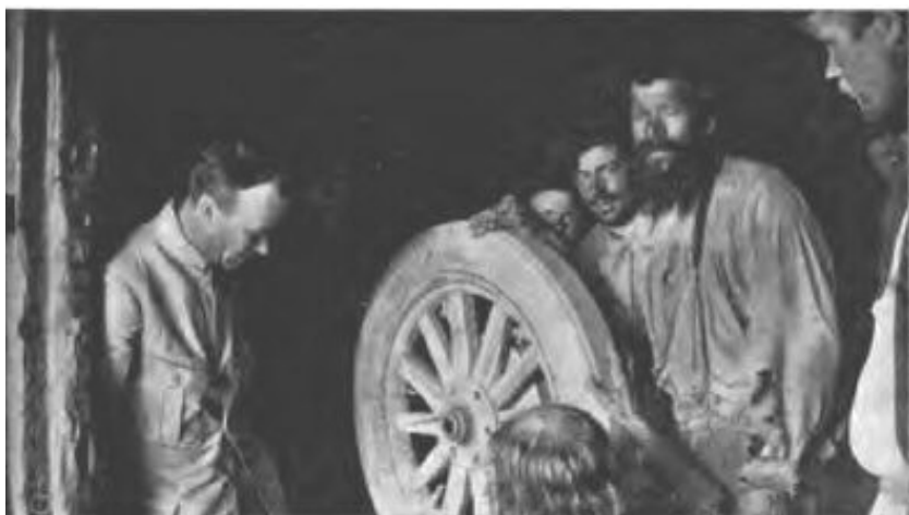
La ruota nuova fabbricata in sette ore da un fabbricante di teleghes e i suoi aiutanti in un villaggio russo tra Perm e Kazan. Fotografia presa nella fucina.
