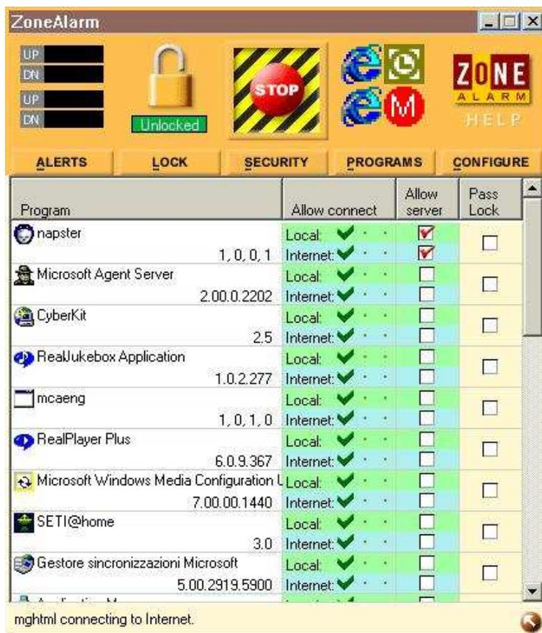
**Figura 18 - L'interfaccia di Zone Alarm permette in ogni momento di controllare le applicazioni autorizzate ad accedere alla rete, e di modificare le impostazioni del firewall**
