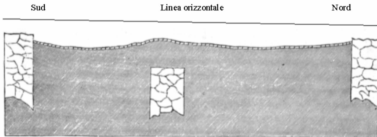
Fig. 15. Sezione praticata nel pavimento abbassato, selciato di tesserae, e dei muri crollati di una stanza a Silchester, che era stata anticamente ingrandita lasciando sepolte le fondamenta del vecchio muro.
