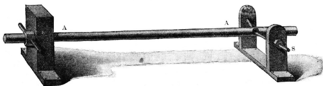
Fig. 134. – Rottura di una sbarra di ferro per contrazione.
