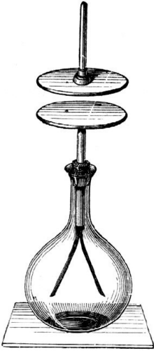
Fig. 285. Elettroscopio con- densatore.
