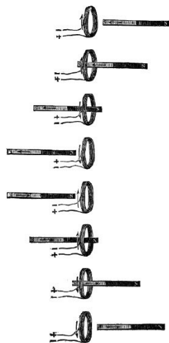
Fig. 320. – Direzione della corrente indotta.
