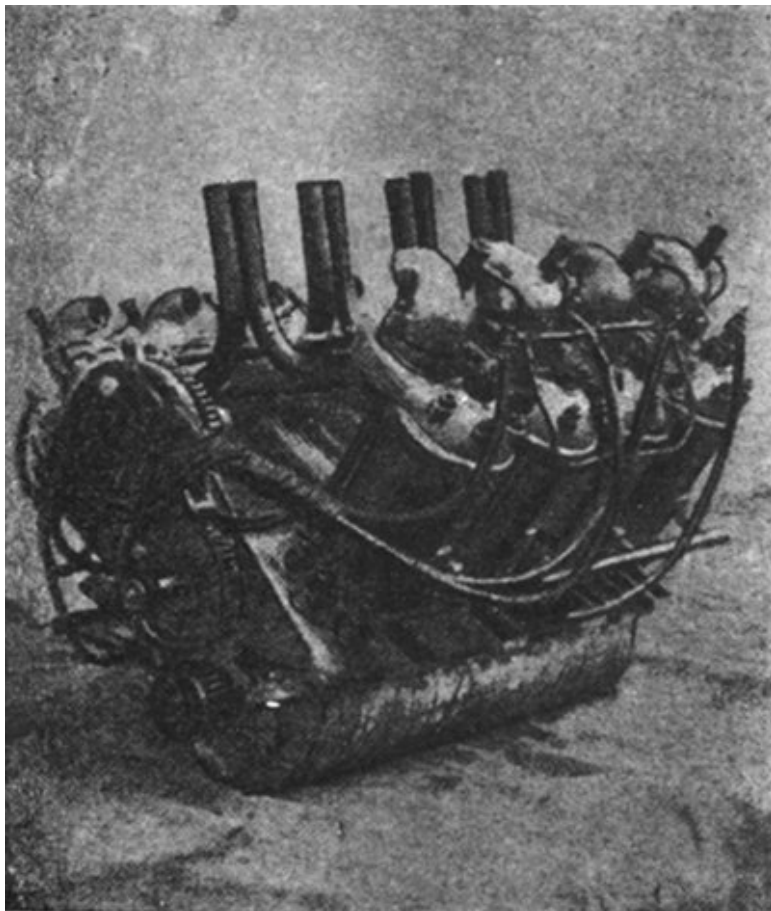
Fig. 113. — Motore da 22 HP del peso di 62 kg.
