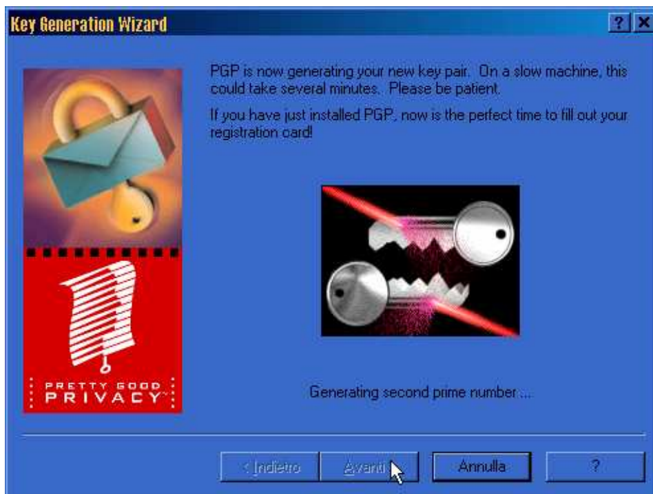
Figura 103 La creazione di una coppia di chiavi PGP. Si tratta di una coppia complementare di numeri primi assai alti. Solo possedendo entrambe le chiavi potremo mettere in chiaro un messaggio cifrato con PGP
